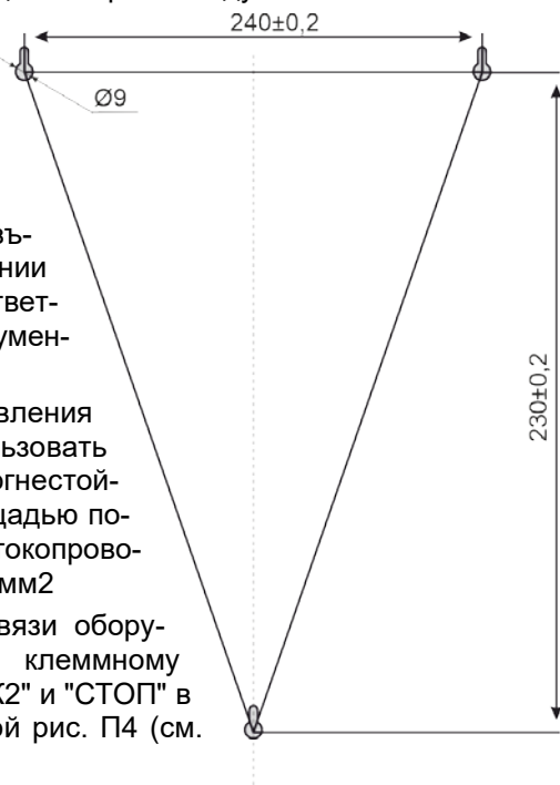
Рисунок 9 Разметка расположения отверстий крепления моноблока (усилителя)
