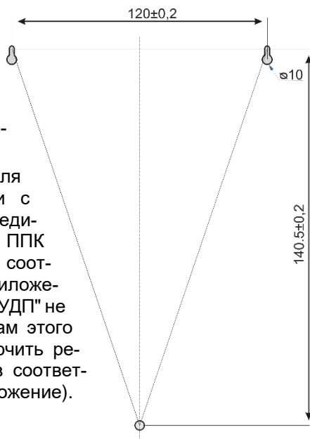
Рисунок 9 Разметка расположения отверстий крепления прибора (блока расширения)
