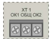
Рисунок 8. Разъемы подключения блока расширения ВИСТЛ-М СО-КЛ БР.
